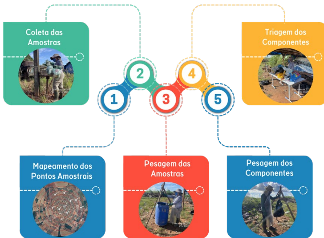
Figura 12. Fluxo dos Procedimentos Executados para a Composição Gravimétrica.
